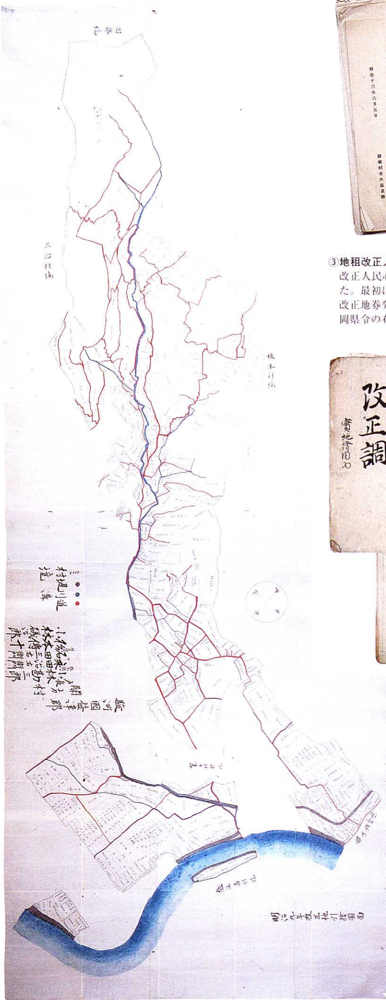
④地租改正調 実地測量の結果を字単位で作図したものを「字限図」という。この「地租改正調」は字限図を編綴したものである。
