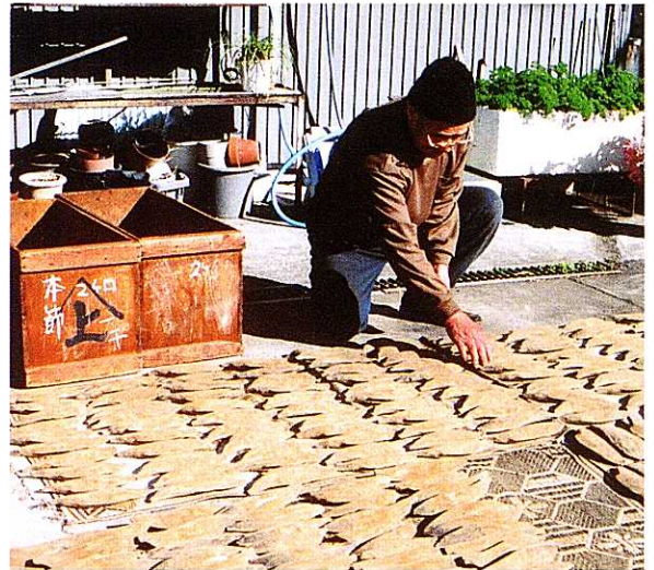
①焼津鯉節製造技術 (市指定) 鯉節を製造する技術。この技術は江戸時代後期に開発されたと考えられ、土佐、伊豆を経て焼津に伝わったといわれる。
